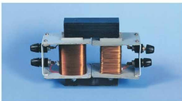
185.3. Mi létesít kapcsolatot a transzformátor primer és szekunder tekercse között?
