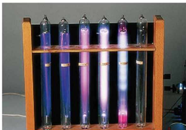
127.3. Kisülési csősorozat: balról jobbra csökken a nyomás
