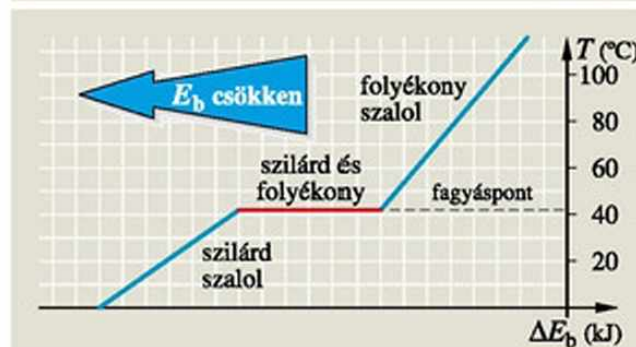
50.2. A szalot hőmérsékletének változása olvadáskor és fagyáskor
