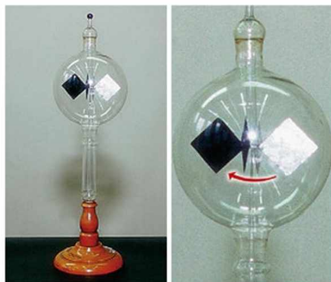
35.1. A „fénymalom” kerekének megvilágításakor forgásba jön. Mitől függ a forgás szögsebessége?
