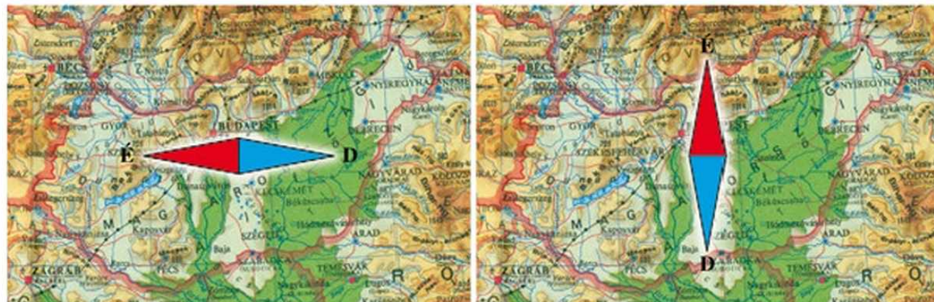
141.1. Maximális forgatónyomatékú (balra), illetve zérus forgatónyomatékú helyzet a Föld mágneses mezőjében
