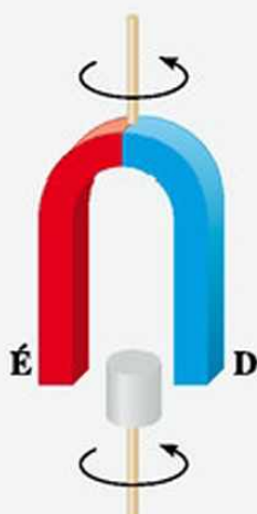
162.2. Az örvényáram forgat: a forgó mágnes az álló Al-hengert forgásba hozza
