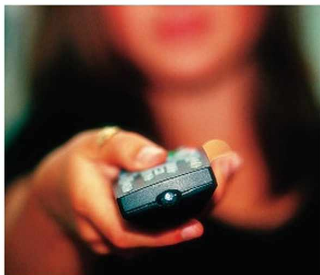
132.2. Infravörös fényt adó LED a távirányítóban
