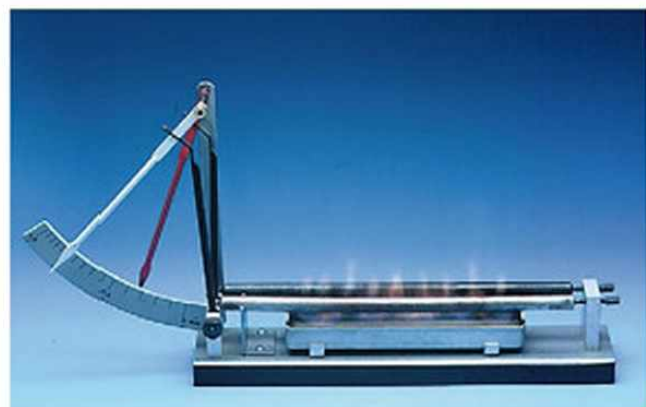
12.1. Szilárd testek lineáris hőtágulását vizsgáló kísérleti eszköz, ahol égő borszesszel melegíthetünk fémrudakat
