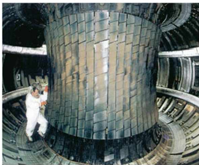
155.3. A toroid tekercs belseje jó mágneses tárolóedény a magas hőmérsékletű plazmához
