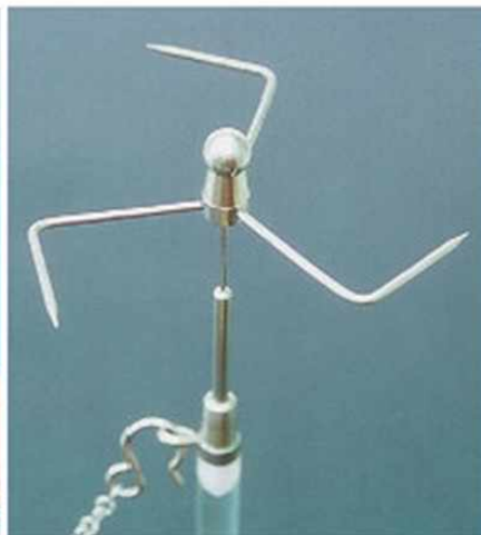
83.2. Az elektromos töltések a vezető csúcsain sűrűsödnek az emberi hajban és az elektromos Segner-keréknél is
