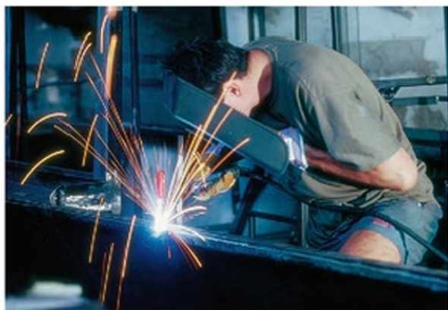
127.1. Az ívkisülés is példa a normális nyomású gázokban folyó áramra. Miért kell védőszemüveg?
