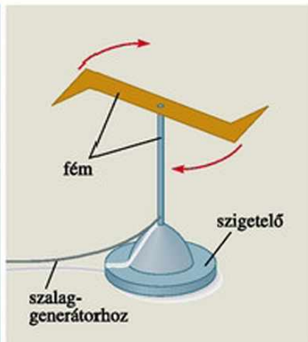
83.2. Az elektromos töltések a vezető csúcsain sűrűsödnek az emberi hajban és az elektromos Segner-keréknél is
