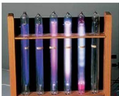
153.2. Kisülési csősorozat: balról jobbra csökken a nyomás
