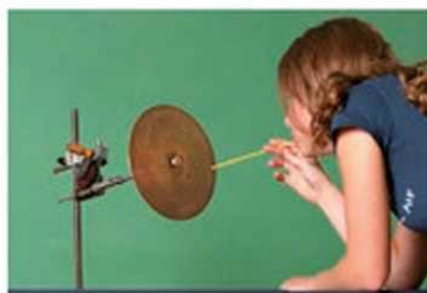
88.4. A lyuksziréna a rezgésszám és a hangmagasság kapcsolatának kimutatására alkalmas eszköz
