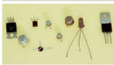
155.4. A tranzisztor szerkezete, rajzjele és technikai kivitelezése
