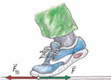
42.1. A láb hátranyomja a Földet, a Föld előre a lábat (hatás-ellenhatás; \vec{F}_{ts} = -\vec{F} ), ezért tudunk elmozdulni
