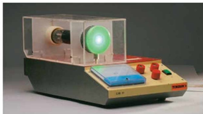
231.3. Elektrondiffrakciós készülék és az annak fluoreszkáló ernyőjén látható elektroninterferenciagyűrűk
