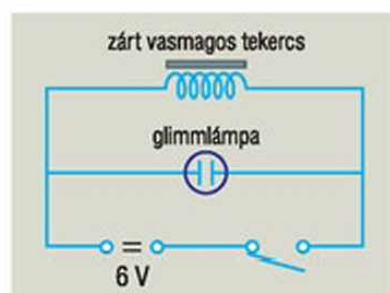
173.2. A tekercs áramának megszakításakor felvillan a 100 V gyújtási feszültségű glimmlámpa
