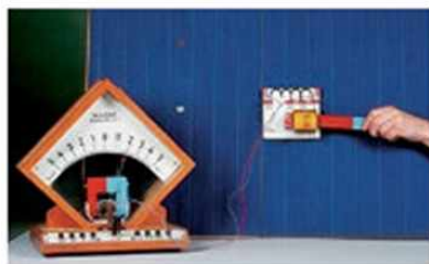
170.1. Ha mágneset közelítünk vagy távolítunk egy tekercshez viszonyítva, a tekercsben feszültség indukálódik
