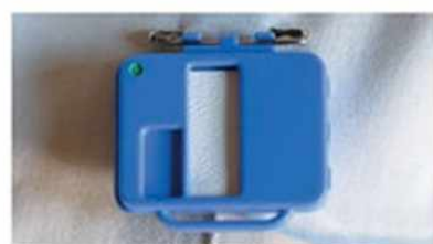
251.3. Az orvosi doziméter egyszerű részecskedetektor, érzékeny lemezen rögzíti a becsapódó részecskék nyomait
