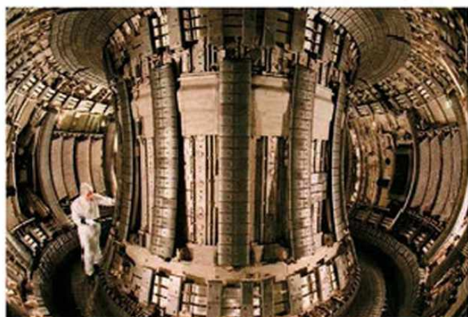
261.1. Kísérleti fúziós reaktor belseje és szerkezetének elvi felépítése
