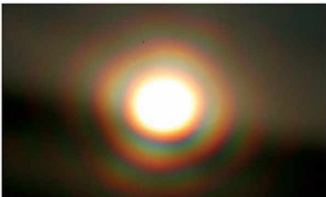
84.1. Ha az izzólámpát kisméretű lyukon át nézzük, akkor a lyuk körül koncentrikus színes interferenciagyűrűket látunk
