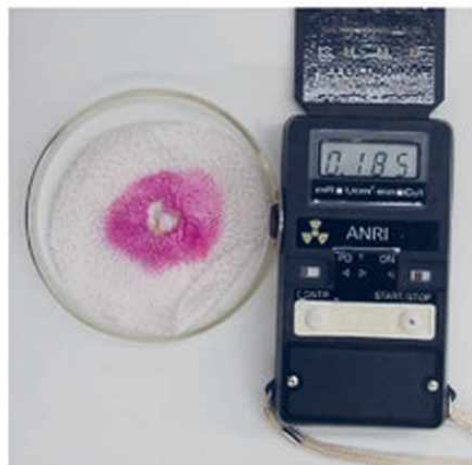
140.1. Radioaktív sugárzás detektálása laboratóriumi (balra) és hordozható Geiger-Müller-számlálóval
