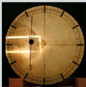
70.2. Teljes visszaverődés alkalmazása képfordító prizmánál 90°-os és 180°-os elfordítások esetén
