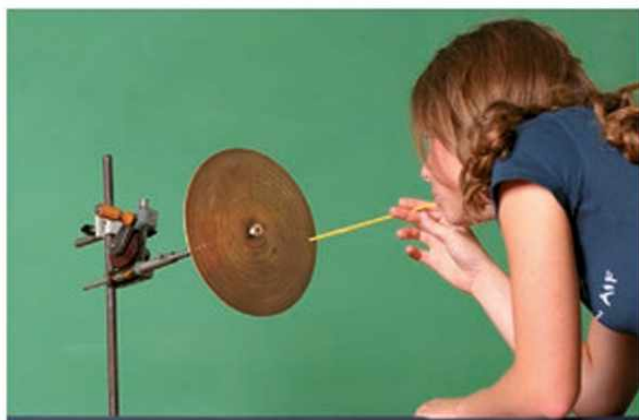
47.2. A lyuksziréna a rezgésszám és a hangmagasság kapcsolatának kimutatására alkalmas eszköz
