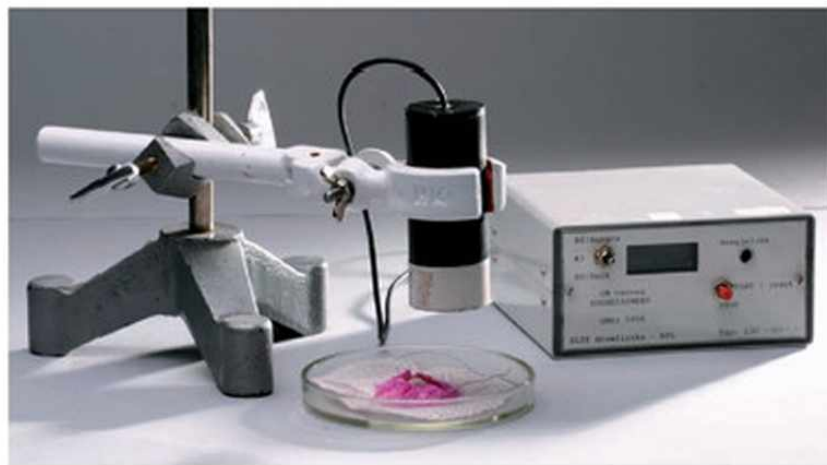
140.1. Radioaktív sugárzás detektálása laboratóriumi (balra) és hordozható Geiger-Müller-számlálóval
