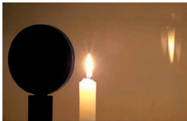
74.2. Gömbtükör képalkotásának vizsgálata
