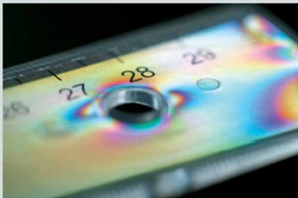
89.1. Polarizált fényben jól látszanak a műanyag vonalzóban ébredő mechanikai feszültségek
