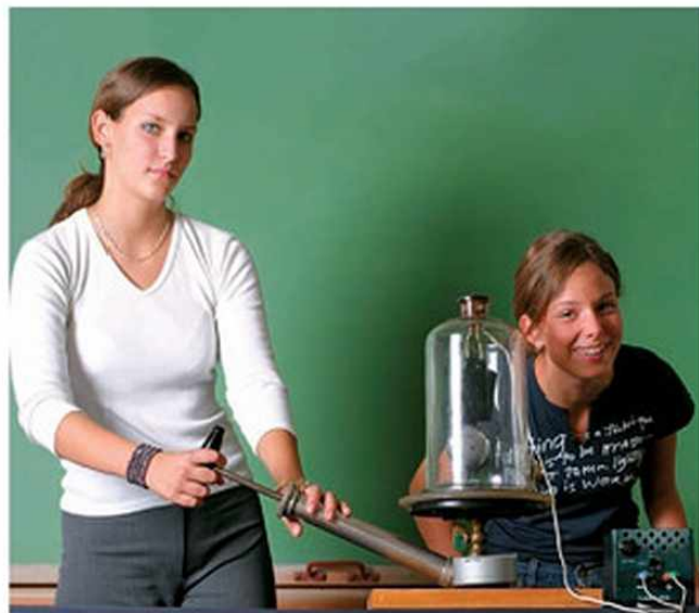
46.3. A működő villanyescengő hangja közvetítő közeg nélkül nem hallható
