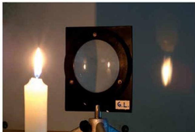
76.1. A lencsék képalkotásának tanulmányozása optikai padon
