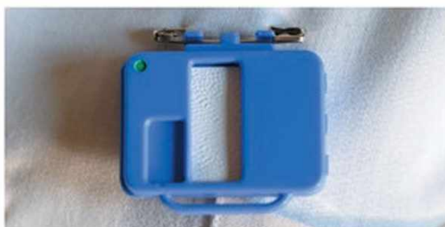
145.3. Az orvosi doziméter egyszerű részecskedetektor, érzékeny lemezen rögzíti a becsapódó részecskék nyomait
