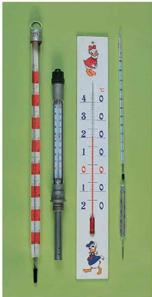
126.2. Különböző célra különböző alakú, skálabeosztású és méréshatárú hőmérőket készítenek.
