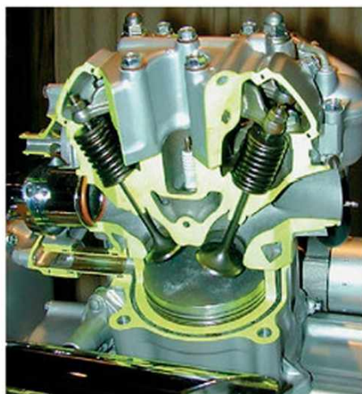
142.2. Egy korszerű benzinmotor metszete.
