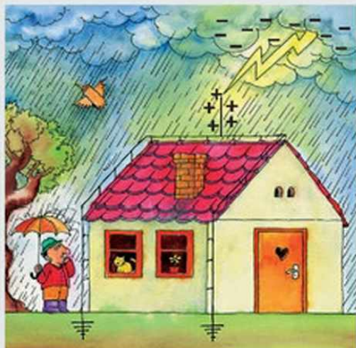
18.2. A villámhárító is földelés. A fémcsúcs magához „vonzza”, a vezeték a földbe vezeti a villámot.
