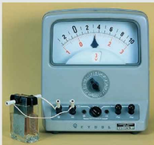
49.1. A hígított kénsavba merülő réz- és cinklemezek között feszültség mérhető.
