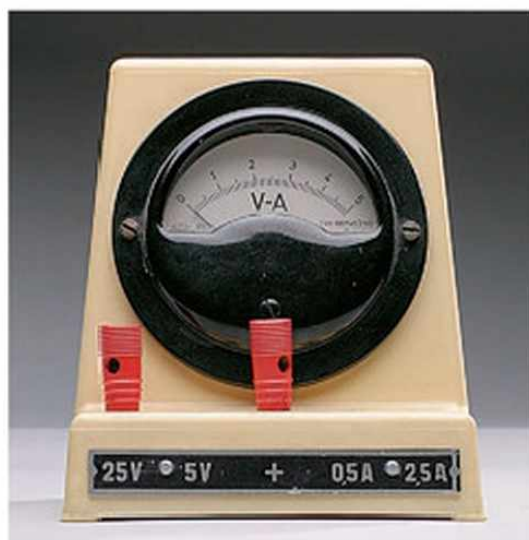
30.1. Ügyelj a polaritás és a méréshatár helyes megválasztására!
