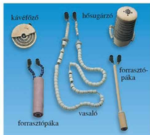
73.3. Az elektromos berendezések fűtőszálainak szigetelése általában kerámia.
