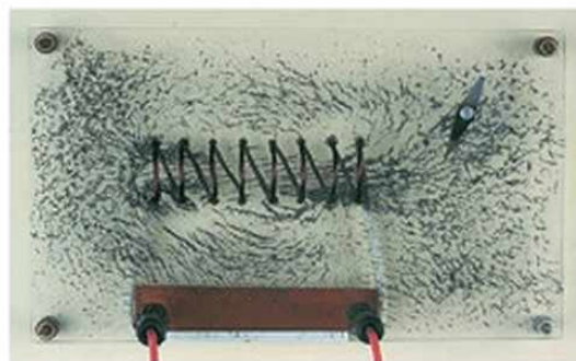
48.2. Az áramjárta tekercs mágneses mezője hasonló a rúd mágnes mágneses mezőjéhez.
